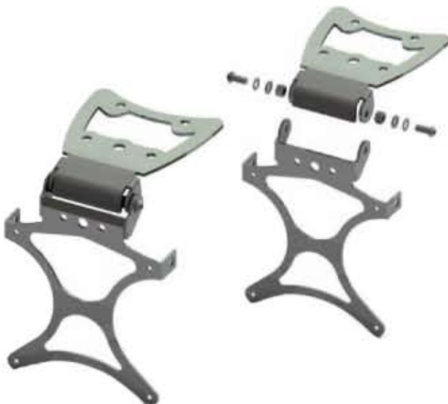
► Rendering di assieme ed esploso di un porta targa Project rendering and exploded drawings of plate carriers
